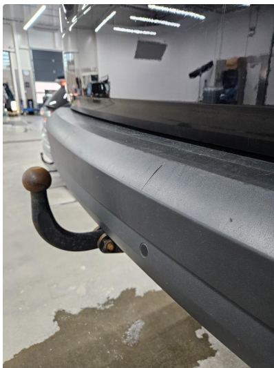
1.10 Noe riper på plast-støtfanger
