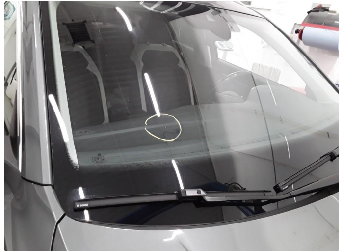
1.7 Steinslag i frontrute. Reparert og limt.
