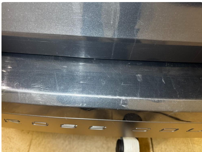
1.3 Noen merker på støtfanger bak
