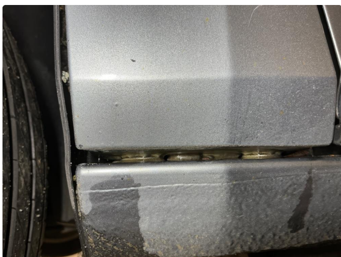
1.5 Skjermer foran høyre og venstre - blærer og smårust
