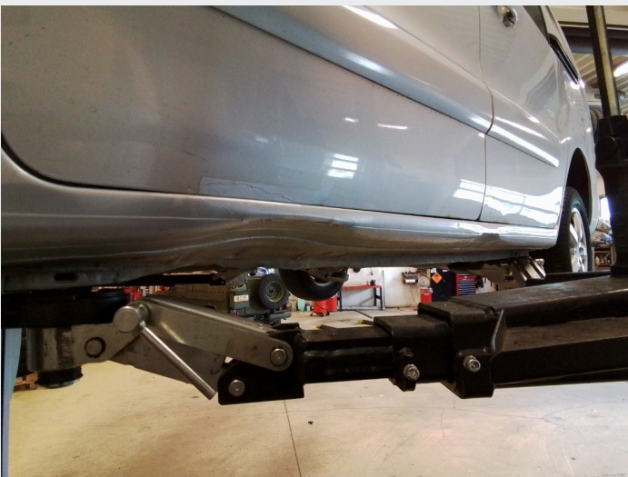
2.4 Bulker og lakkskader på kanal venstre side
