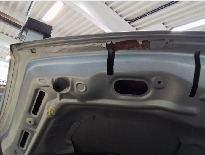
2.3 Rust på underside av panser
