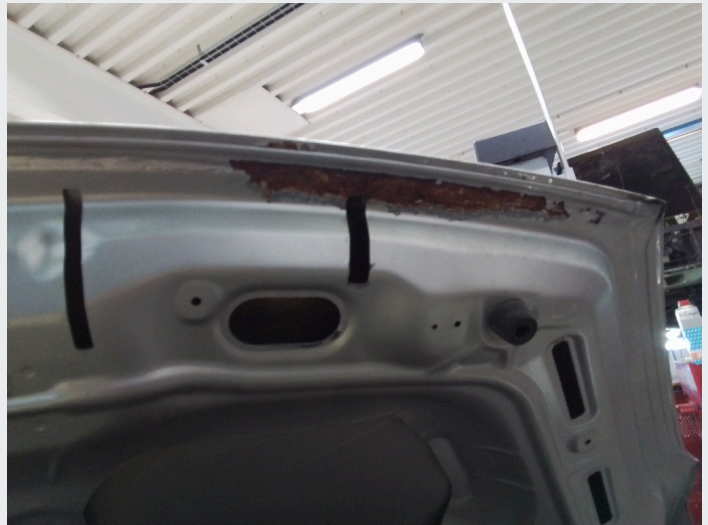
2.3 Rust på underside av panser
