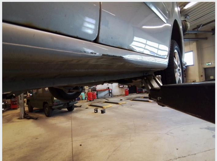
2.4 Bulker og lakkskader på kanal venstre side
