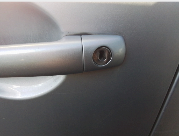
2.5 Skadet nøkkellås førerdør, men lås virker
