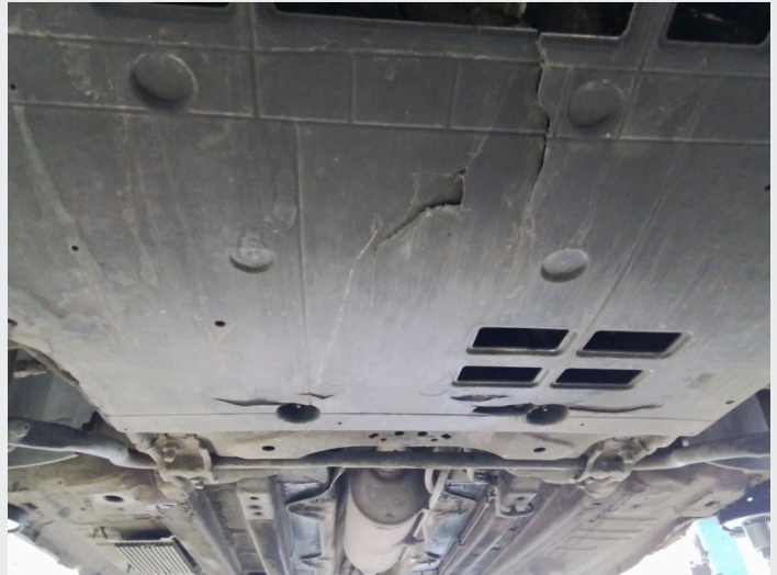
2.2 Skade på bukplate under motor
