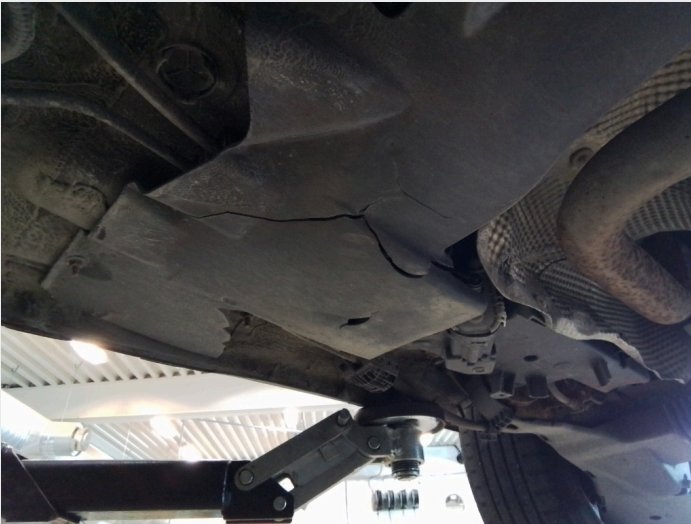
2.2 Skade på plastikk under bil foran høyre bakhjul
