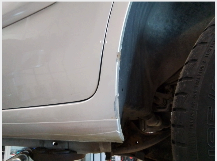
2.1 Lakkskader og rustbobler er å finne på hele bil
