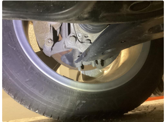
2.1 Påbegynt rust innside forran, bil må kjøres
