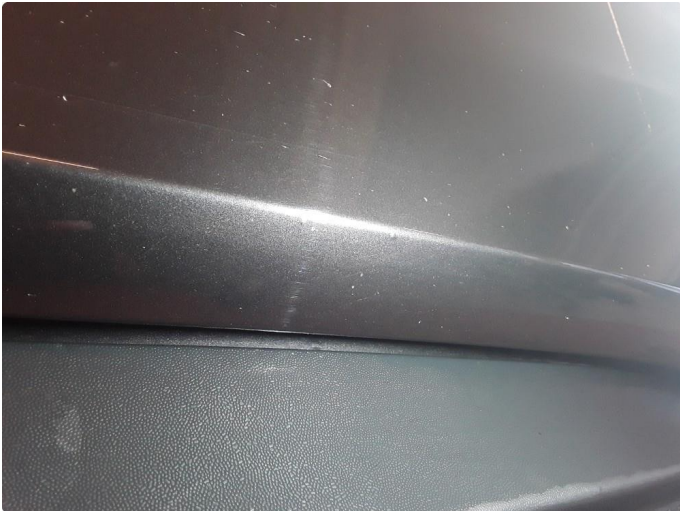
1.2 Liten steinsprut med korrosjon høyre fordør.
