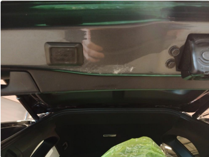
1.1 Mye riper og lakkskader. GJELDER OVERFLATE.
