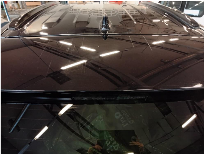
1.1 Mye riper og lakkskader. GJELDER OVERFLATE.
