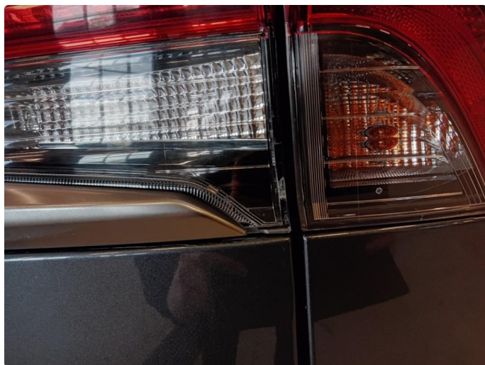
2.1 Sprekk i lampe bak på bakluke, v. side. VURDERES VED SALG.
