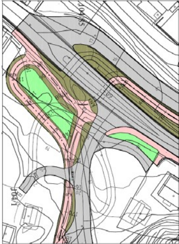
Figur 25: Illustrasjon av undergang og rampesystem, av KSO.
