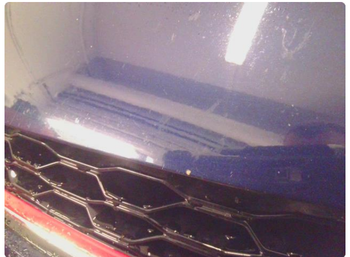
1.2 Noe steinsprut med rust
