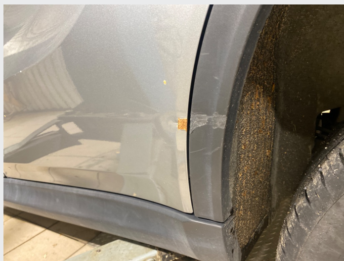
2.5 Skade venstre bakdør
