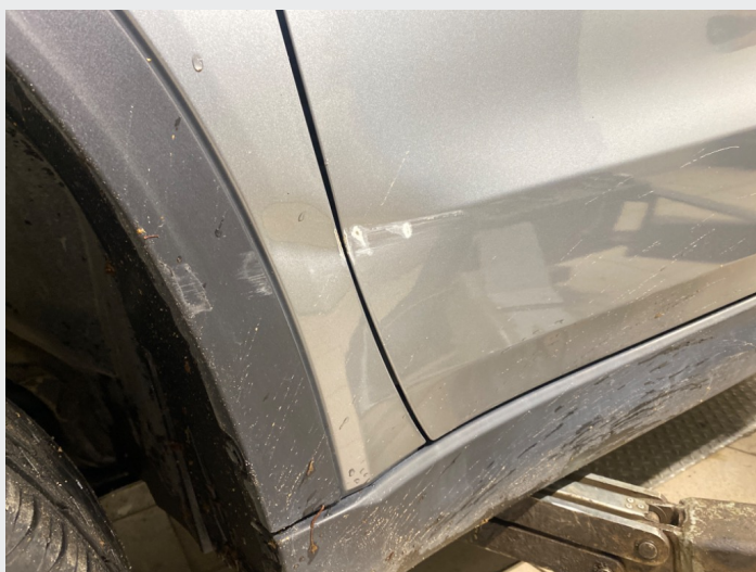
2.5 Skade venstre fordør
