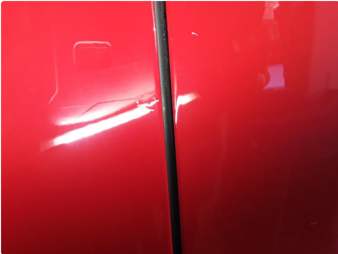
1.2 Steinsprut med korrosjon.
