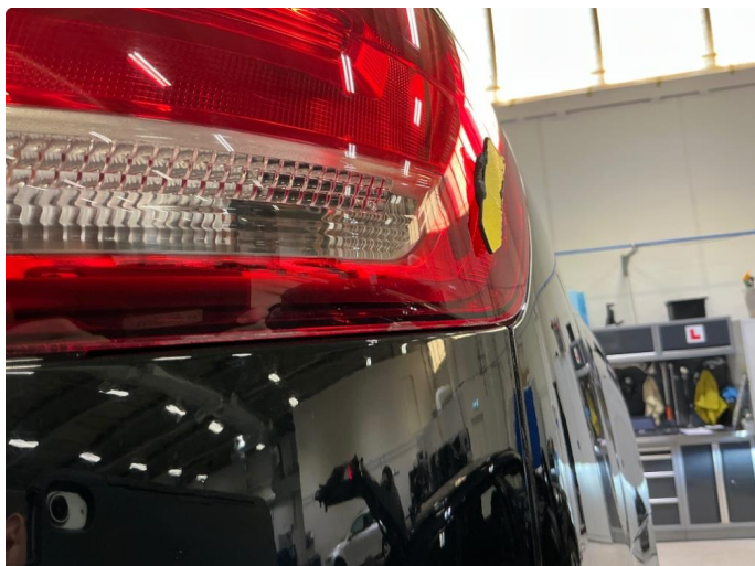
2.1 Krakelering i plast, høyre ytre baklykt
