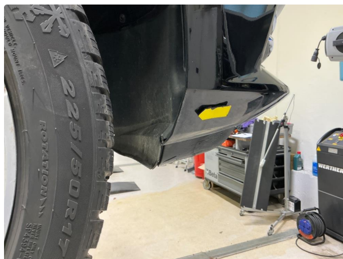
1.10 Riper, støtfangerkappe foran høyre side mot hjulbue
