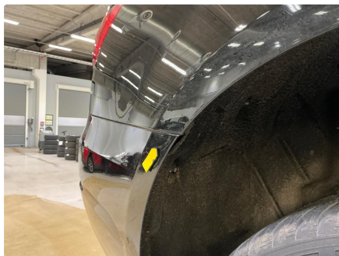
1.8 Høyre hjørne til støtfangerkappe bak stikker noe ut i forhold til høyre baksjerm
