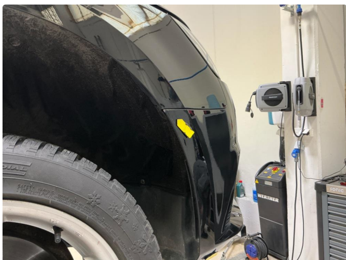
1.9 Høyre hjørne til støtfangerkappe foran stikker noe ut i forhold til forskjerm
