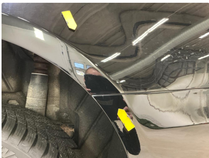
1.7 Lakkert over en tidligere skade venstre baksjerm og støtfangerkappe bak
