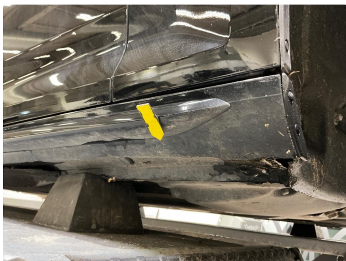
1.13 Klarlakkflask og bulk høyre kanal i fremkant
