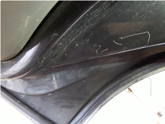
1.2 Noe riper innvendig venstre fordør.
