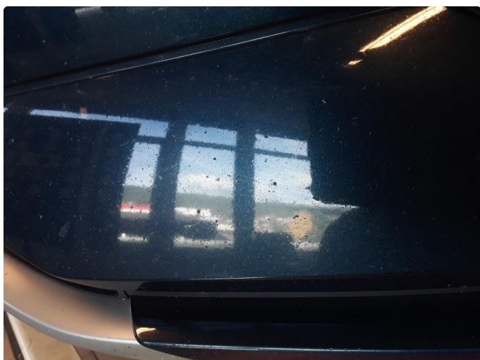
1.2 Noe steinsprut og riper.
