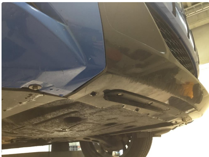
1.7 Skrubbskader underkant frontfanger
