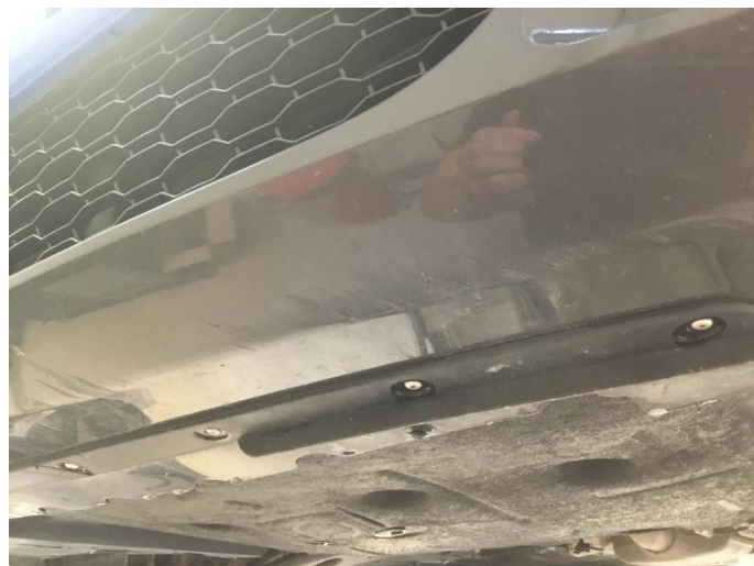
1.7 Skrubbskader underkant frontfanger
