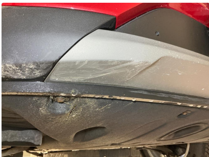
1.10 Fanger foran , skrubbskader underkant
