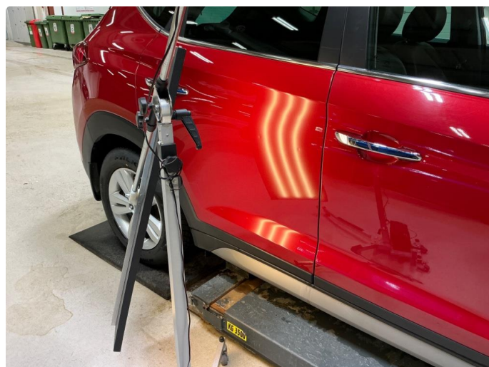
1.3 Bulk med lakksår høyre bakdør .
