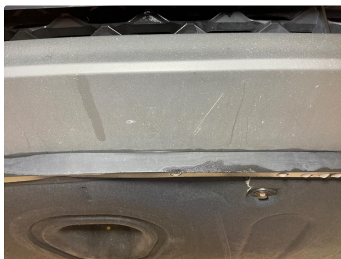
1.10 Fanger foran , skrubbskader underkant
