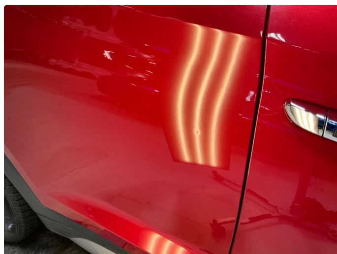
1.3 Bulk med lakksår høyre bakdør .
