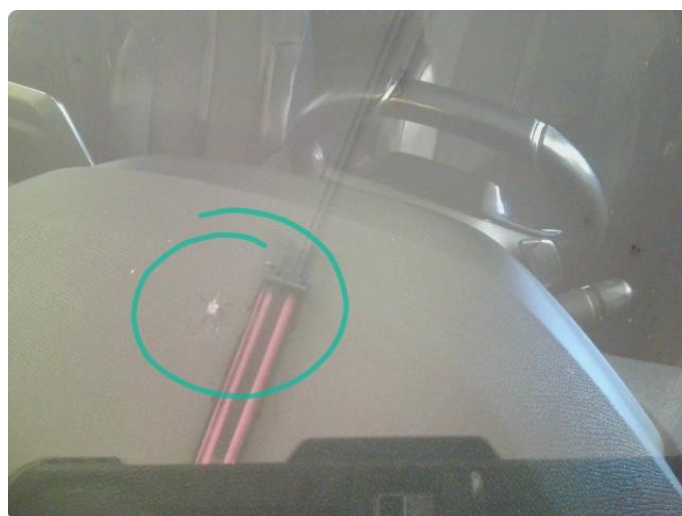
2.7 Steinsprut med sprekk i synsfelt
