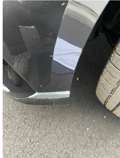
1.3 Ripe(r) ned til grunning
