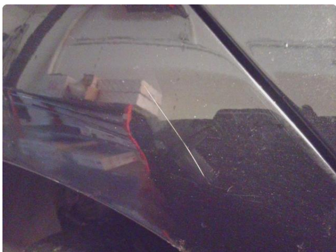
1.3 Ripe(r) ned til grunning
