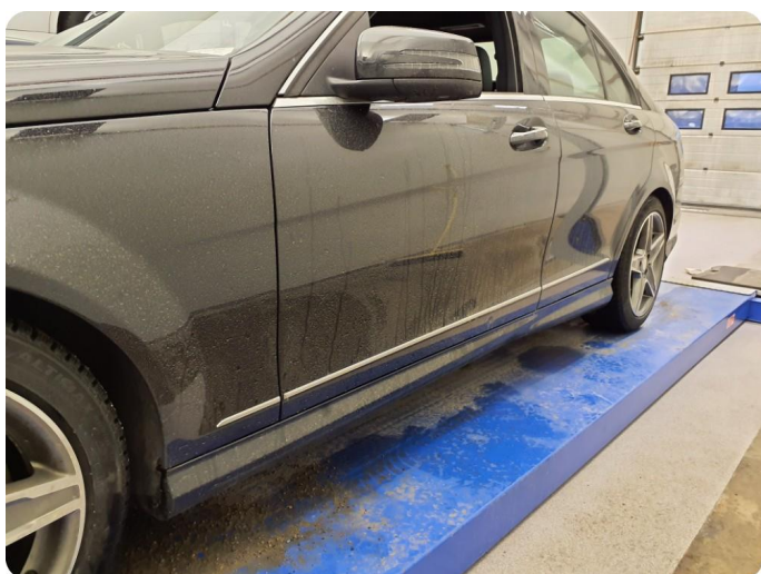
3.1 Forurensing lakk ytre påvirkning Møkkete bil, lakk ikke kontrollert nøye
