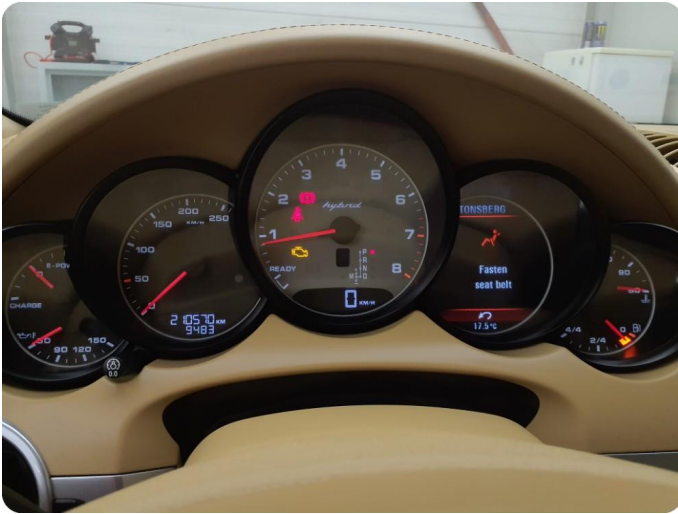
2.1 Varsellampe lyser se bilde Motorlampe lyser
