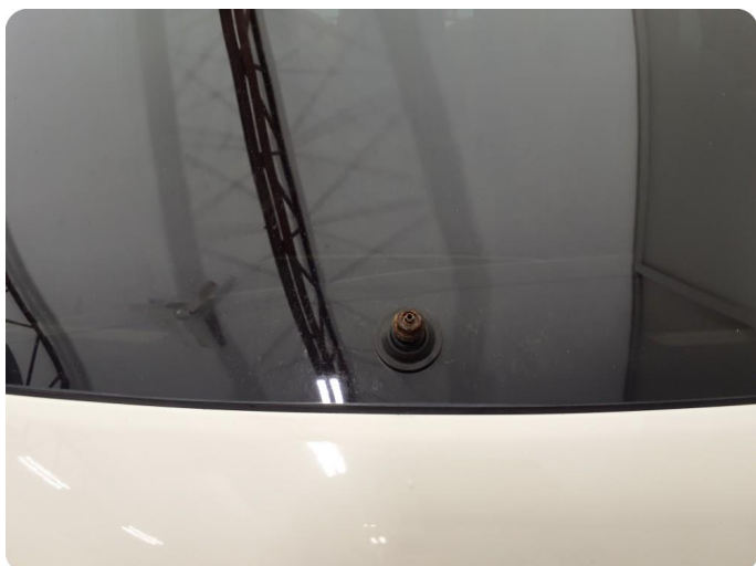
3.4 Øvrige feil Mangler pusserarm og dyse bak, spylar tjukk stråle bakover
