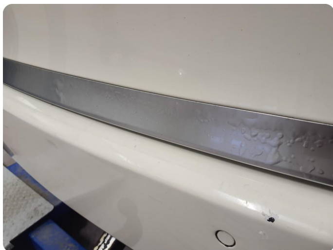
3.3 Løse/skadede lister List på bakluke har mye boble dannelser
