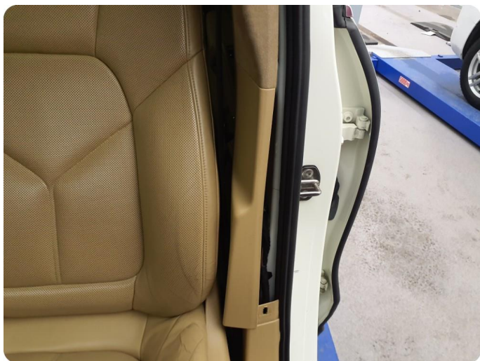
7.2 Løst B stolpe deksel løst
