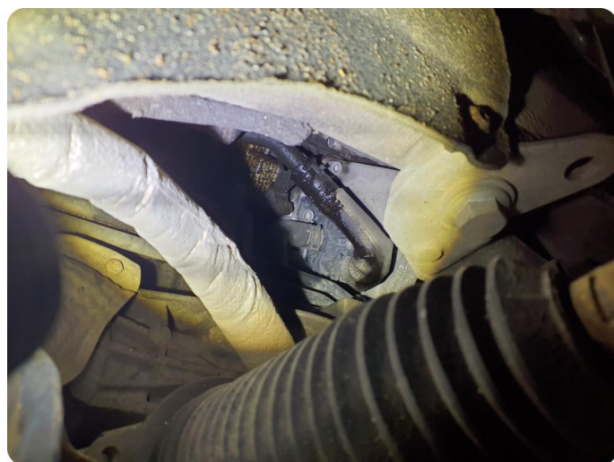
4.1 Oljelekkasje fra motor
