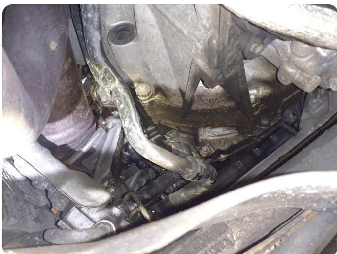
4.1 Oljelekkasje fra motor
