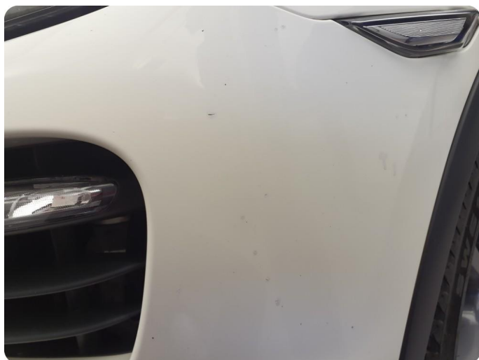
3.1 Generelt mye riper og småbulker Inkluderer skade ,steinsprut, riper, rust
