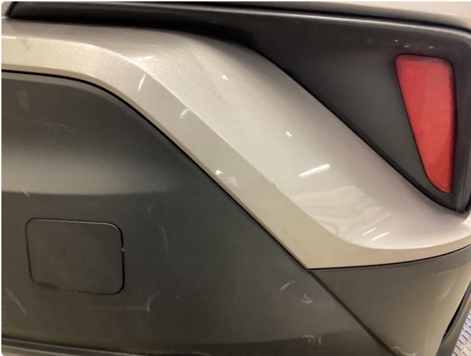
1.1 Noen små riper på bak på fanger. Høyre side.
