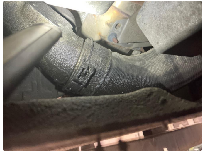
2.1 Noe svetteing fra underside motor
