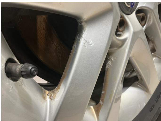
1.5 Vinterfelger - sår og noe korrosjon
