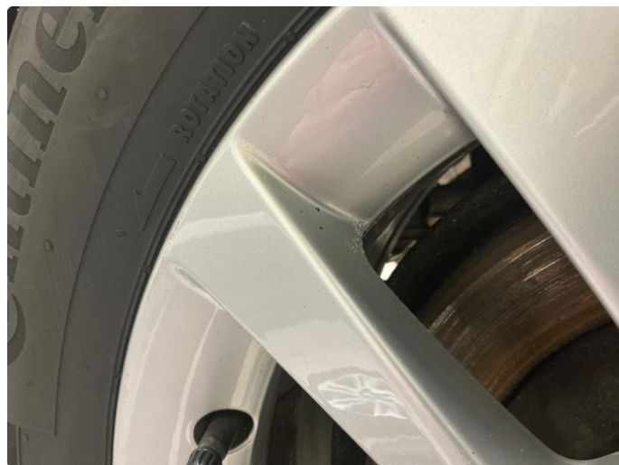
1.5 Vinterfelger - sår og noe korrosjon
