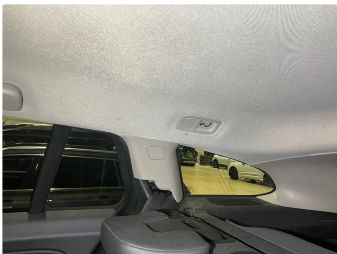
3.2 Noe flekker i taktrekk
