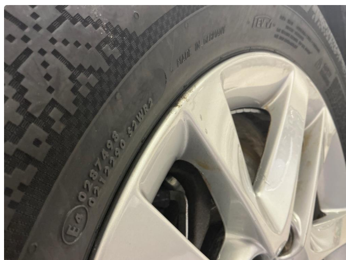
1.5 Vinterfelger - sår og noe korrosjon
