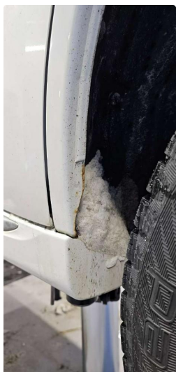
1.1 Små steinsprut sår på underside skjerm
