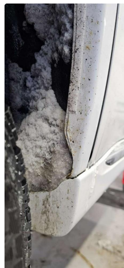
1.1 Små steinsprut sår på underside skjerm
