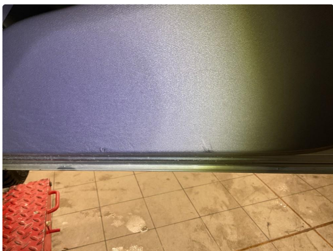
3.1 Små merker under dørtrekk høyre foran
