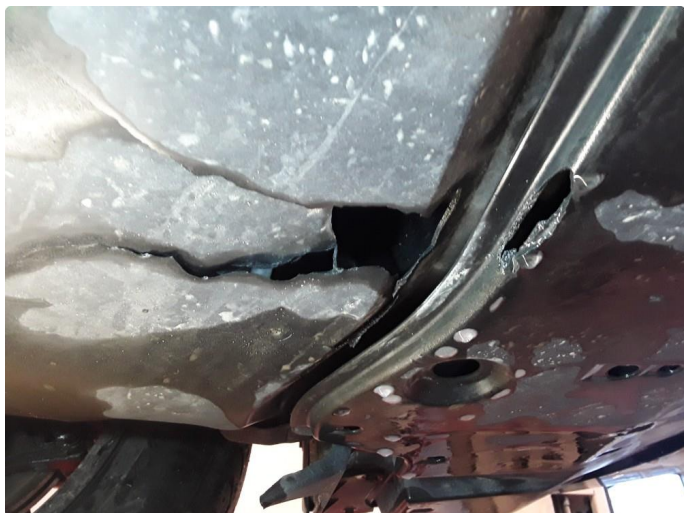
1.2 Noe skadet beskyttelsesplate under vogn.
