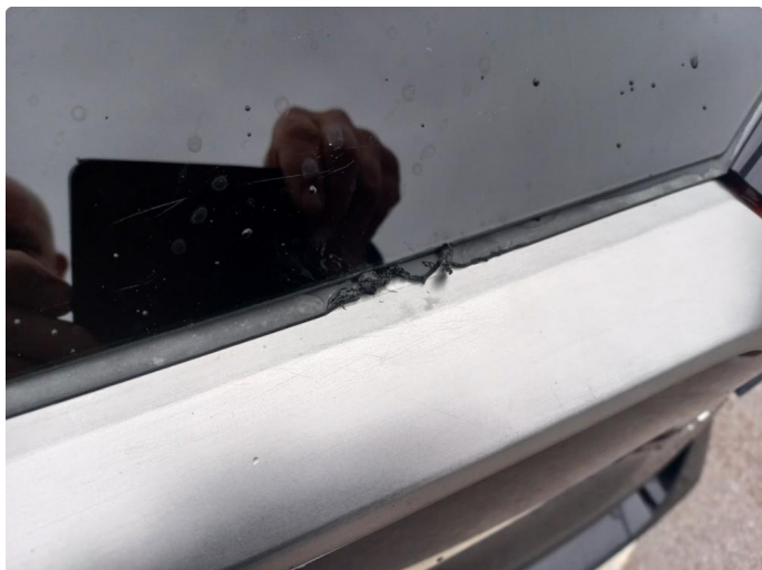
1.4 Noe skadet pakning.
