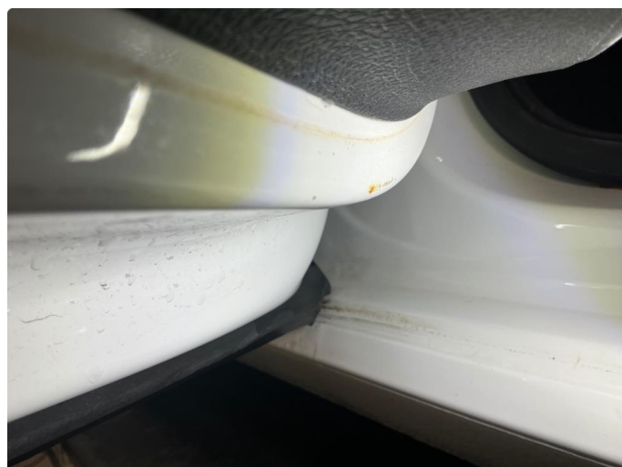
1.4 Venstre bakdør innvendig, rust/korrosjon
