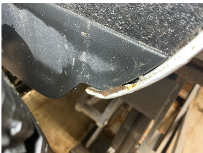
1.6 Høyre bakskjerm , rust
