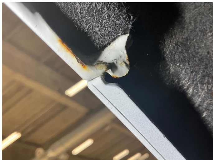
1.6 Høyre bakskjerm , rust
