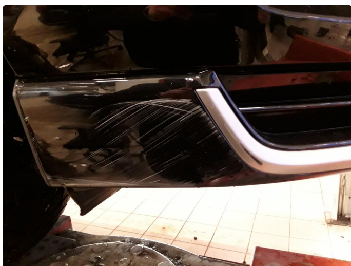
1.4 Noen riper høyre side nedre del.
