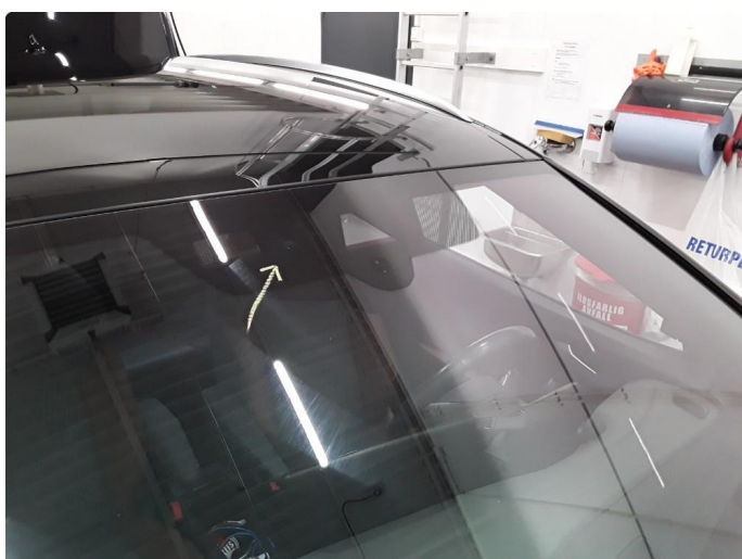
1.2 Noe synlig slitasje på frontruten. Normal bruksslitasje
