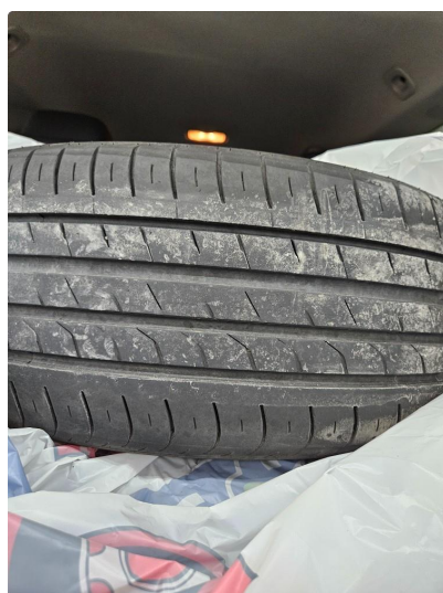
2.2 Noe kantslitasje på dekk
