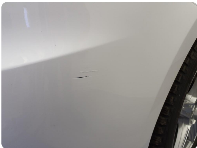
3.1 Øvrige feil Generelt mye riper, små bulker, lakksprekker, steinsprut, osv. Hele bilen
