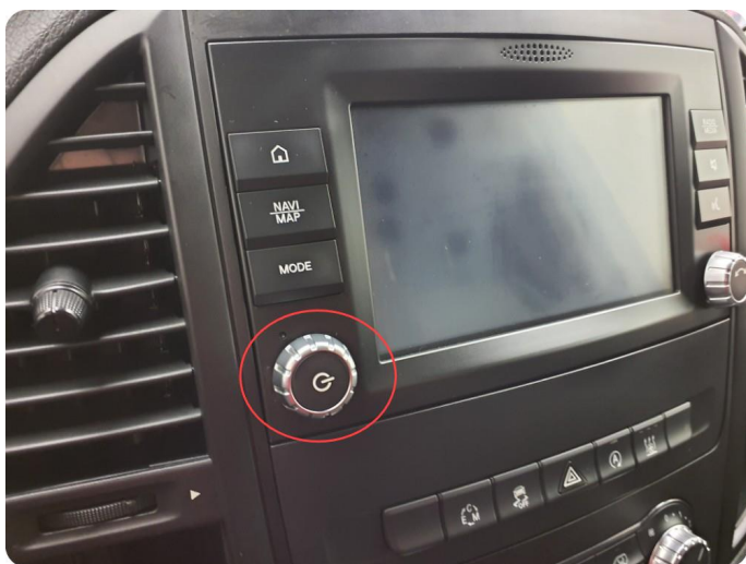
5.2 Øvrige feil Bryter virker ikke. Må kontrolleres
