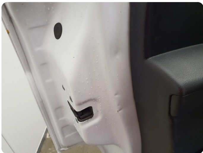
3.3 Øvrige feil Bulk,rust innside dør begge foran
