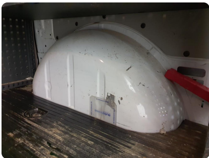
5.3 Demontering av innredning/utstyr Tillegg merker,riper bruksslitasje i hele varerom
