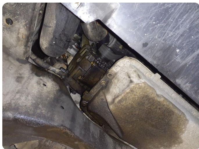
4.1 Svetter Må kontrolleres
