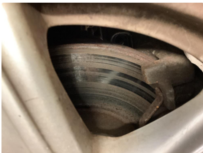
2.1 Litt over flate rust på skiver OK PÅ Service
