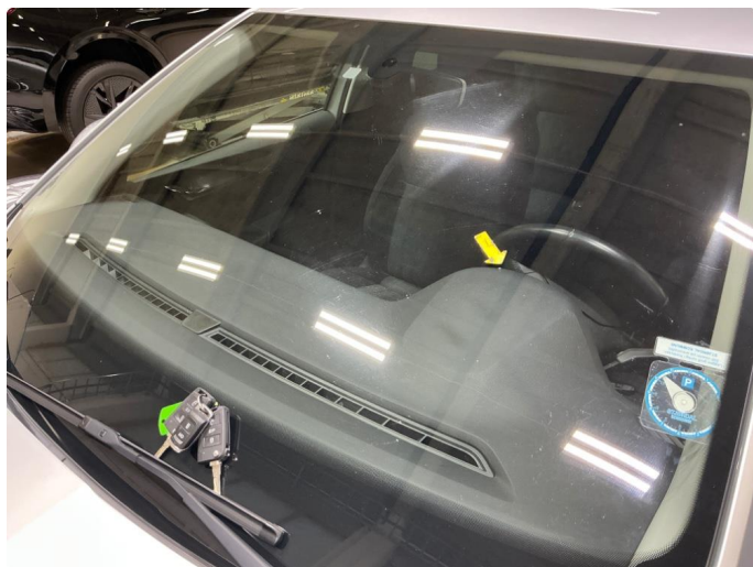
3.7 Flere små steinsprutskader på frontrute.
