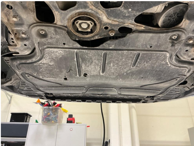
3.1 Skade på plate under motor.
