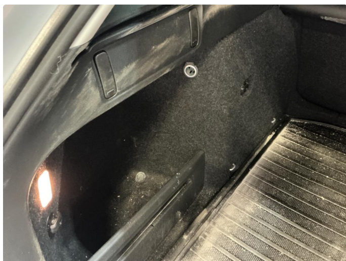
4.2 Lokk 12 v uttak bagasjerom mangler.
