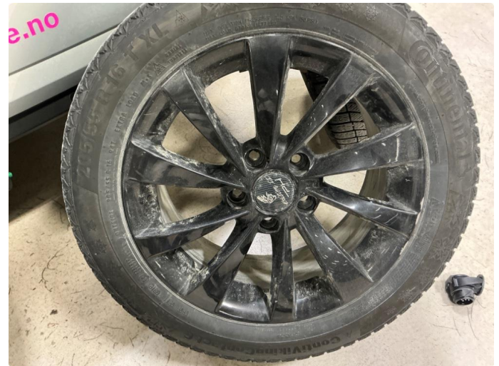
3.2 Kosmetisk skade på vinterfelger. . Alle vinterfelgene er korroderte.
