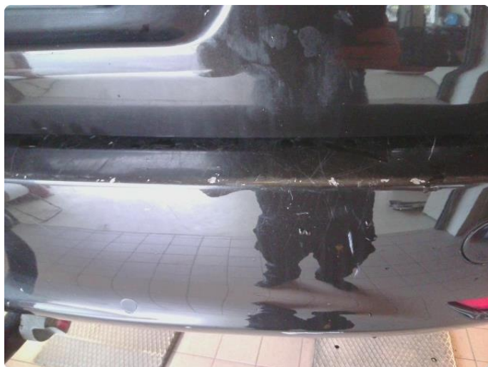
2.11 Ripe(r) ned til grunning
