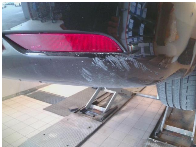
2.11 Ripe(r) ned til grunning
