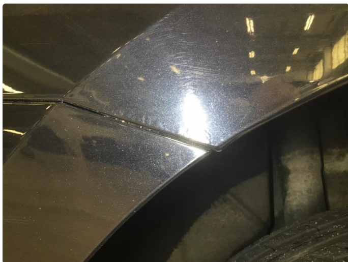
1.6 Høyre bakskjerm - rust og bulk
