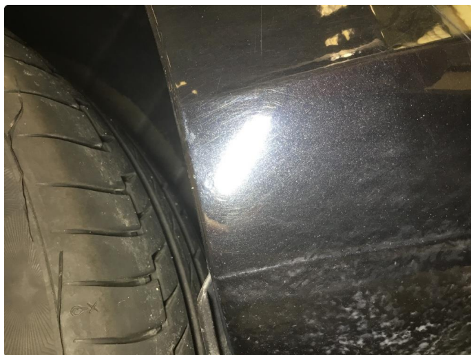
1.6 Høyre bakskjerm - rust og bulk
