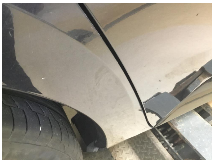
1.6 Høyre bakskjerm - rust og bulk
