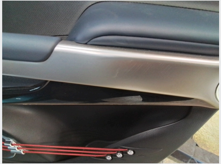
4.4 Riper i dørtrekk høyre bakdør
