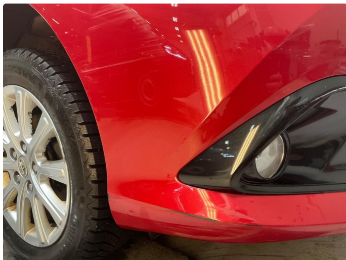
1.13 Høye fangerhjørne foran - løst spylendecksel
