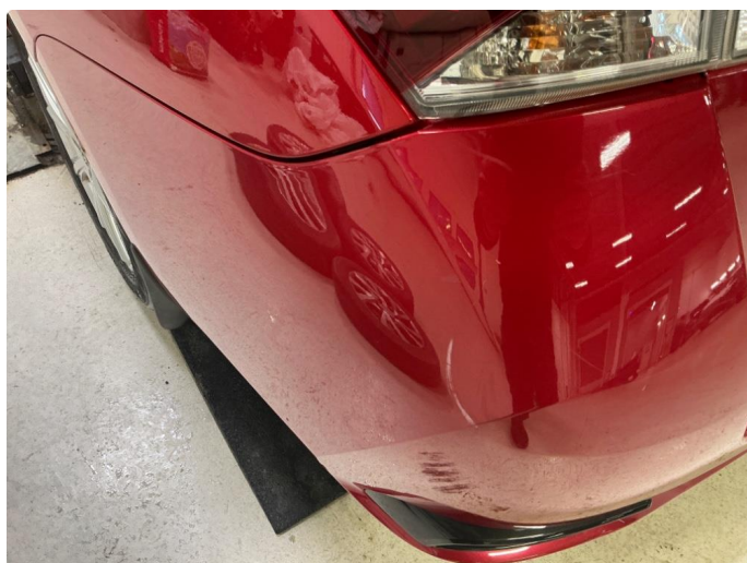
1.12 Fanger bak - skader, bulk og sår
