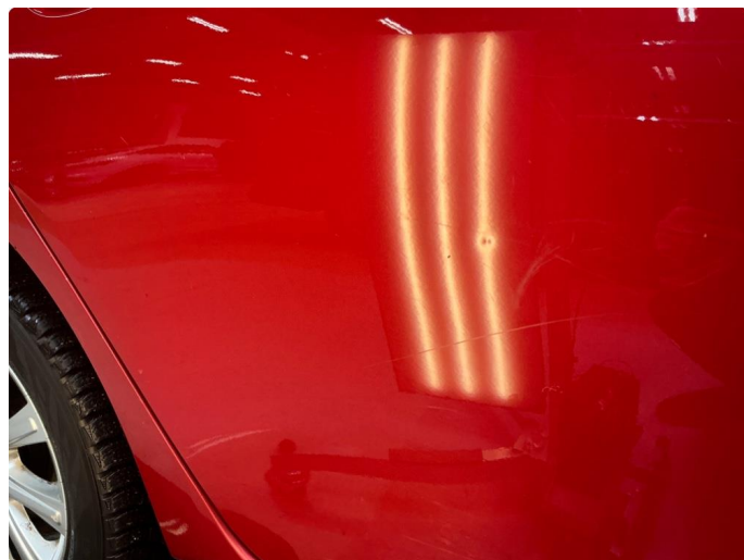
1.5 Høyre bakdør - flere bulker
