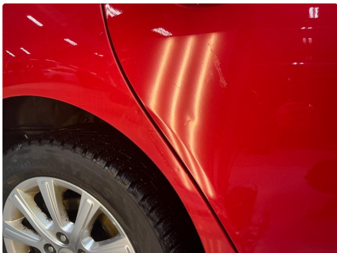
1.5 Høyre bakdør - flere bulker
