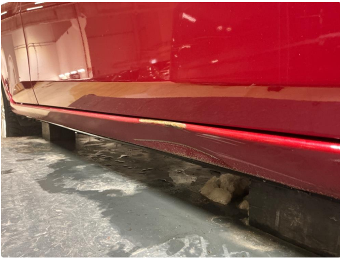
1.15 Bulk med lakkskade høyre side
