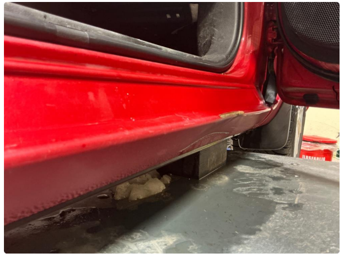
1.15 Bulk med lakkskade høyre side
