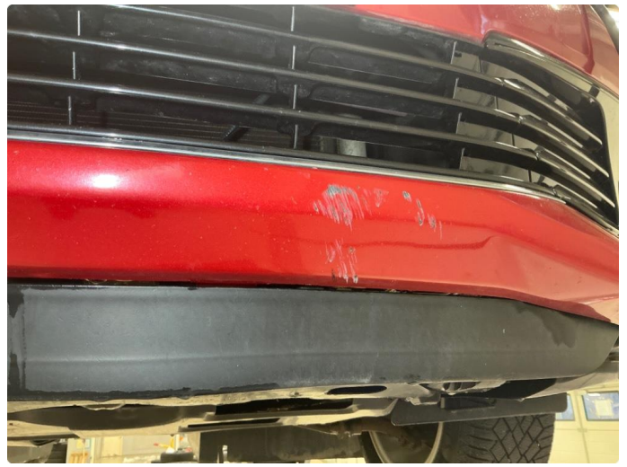
1.14 Fanger foran ,skrubbskader underkant
