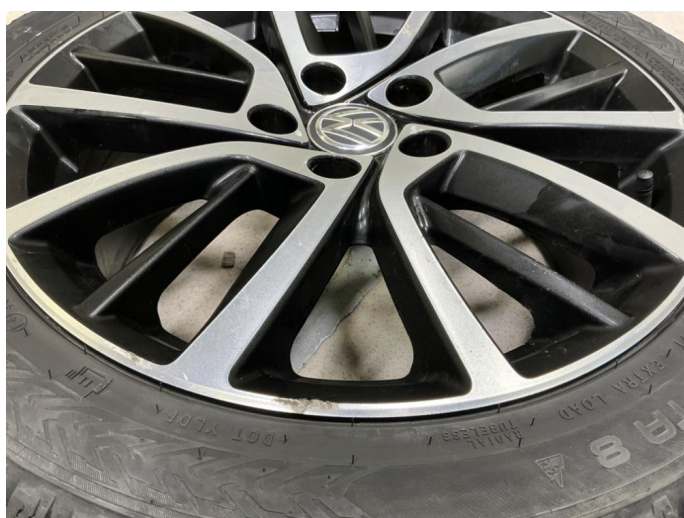
1.6 Graverende kantkjøringer og oksidering - vinterhjul
