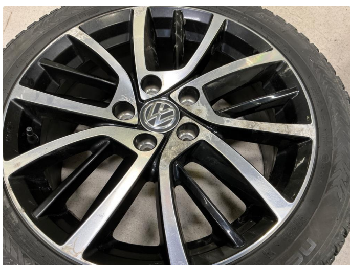
1.6 Graverende kantkjøringer og oksidering - vinterhjul
