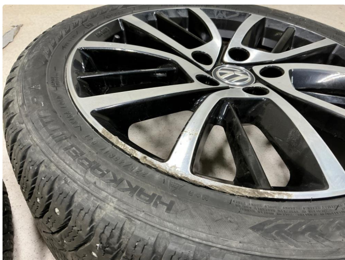
1.6 Graverende kantkjøringer og oksidering - vinterhjul
