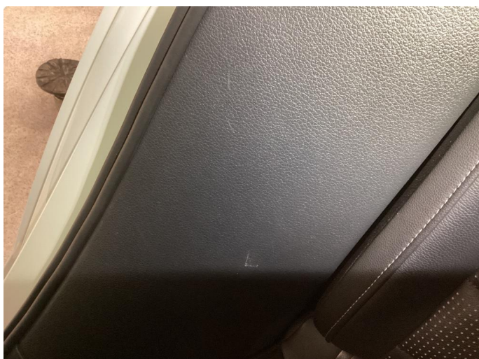
3.1 Lite merke dørtrekk høyre bak
