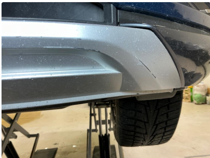
1.7 Fanger foran, skrubbskader underkant
