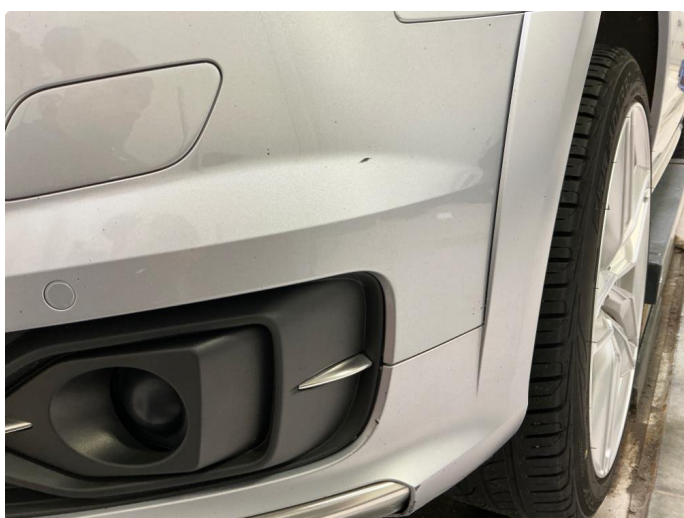
1.5 Støtfanger foran - steinsprut, sår og mekanisk slitasje
