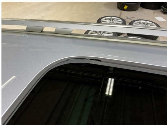
1.12 Defekt ramme/pakning panorama soltak
