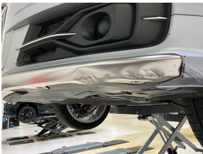
1.8 Nedre spoiler/diffuser skadet/bulket
