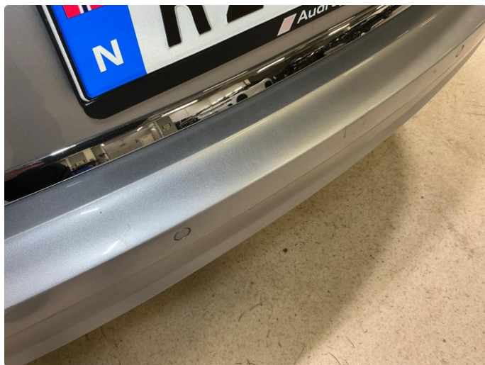
1.4 Innlasting bakfanger - mekanisk slitasje og riper
