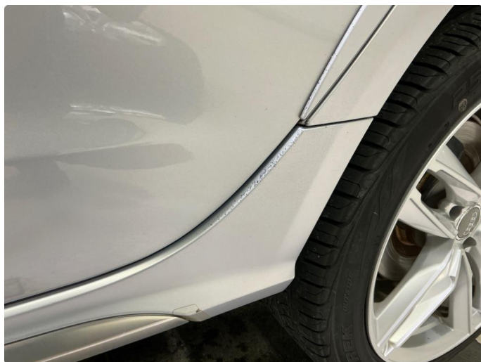
1.14 Plastlister kanal noe slitt bak begge sider
