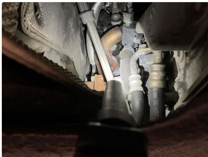
3.1 Noe oljesvetting fra bakkant venstre side - ok
