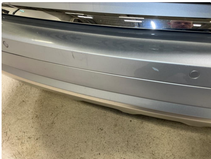
1.4 Innlasting bakfanger - mekanisk slitasje og riper
