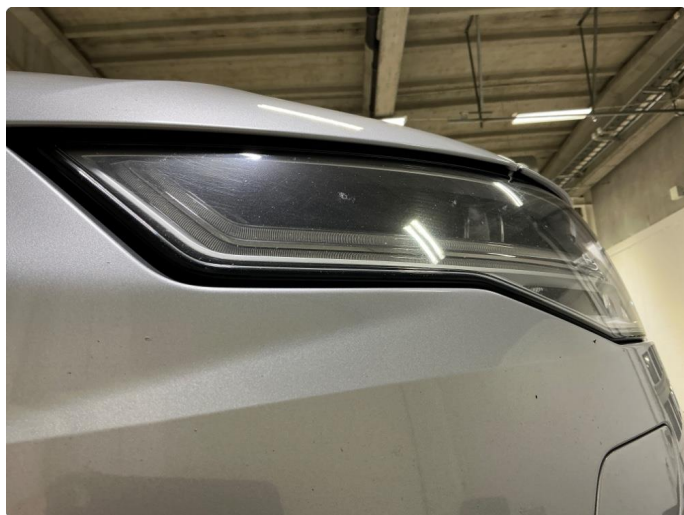
2.1 Noe slitte lykteglass
