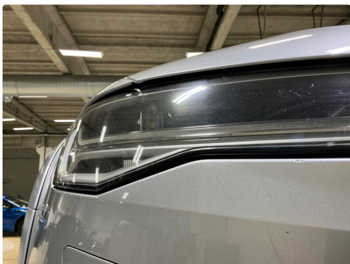
2.1 Noe slitte lykteglass
