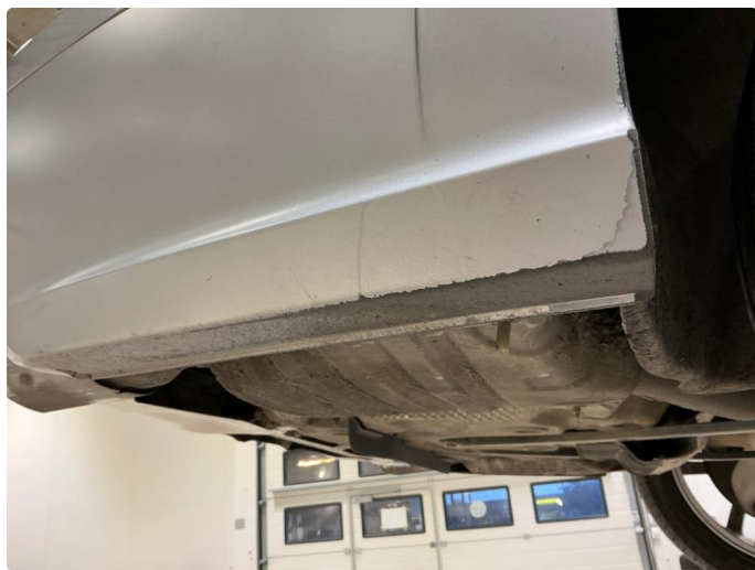
1.7 Støtfanger bak - lakklass bak hjul
