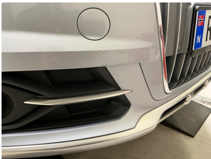
1.5 Støtfanger foran - steinsprut, sår og mekanisk slitasje
