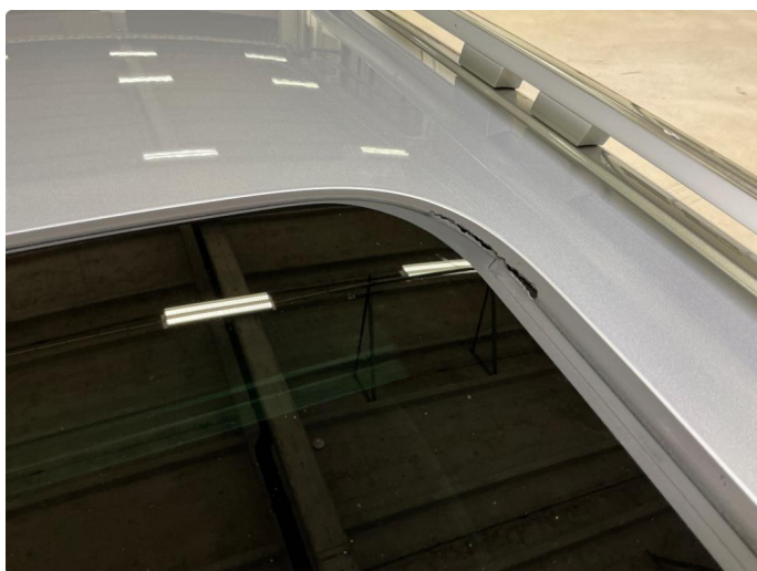
1.12 Defekt ramme/pakning panorama soltak
