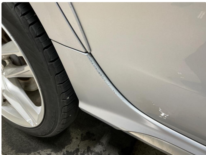
1.14 Plastlister kanal noe slitt bak begge sider
