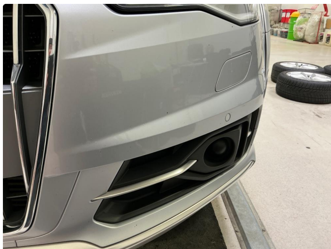
1.5 Støtfanger foran - steinsprut, sår og mekanisk slitasje
