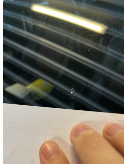
1.2 Steinsprut med sprekk
