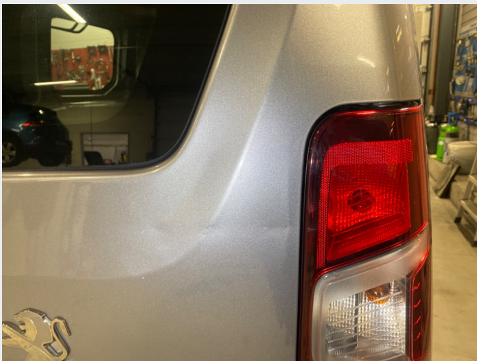
2.5 Bakluke høyre side ved lykt, skade/bulk
