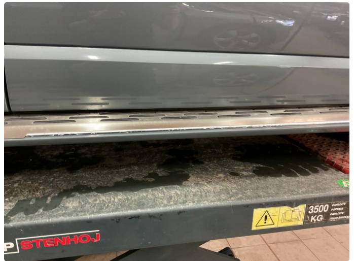
1.5 Stigetrinn begge sider vil bli byttet ut til vanlige kanaldeksele av praktisk årsak
