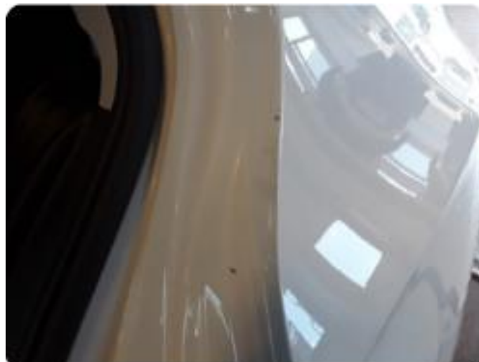
1.3 Noen lakksår i døråpning venstre bak. Blir penslet.
