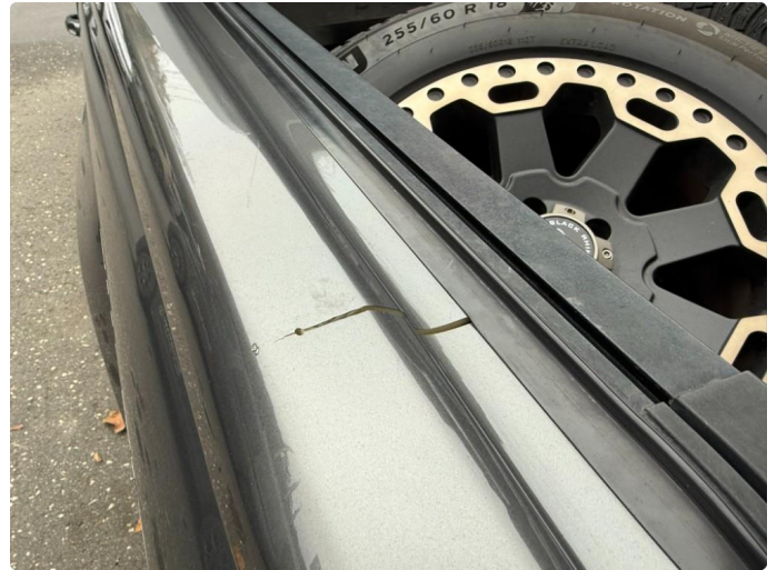
1.2 Sprekk i plastikk tilhørende bøyle, har ingen funksjon og er kun kosmetisk
