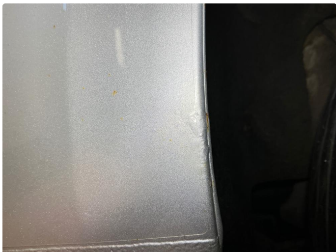
1.7 Høyre og Venstre bakskjerm - rust/korrosjon
