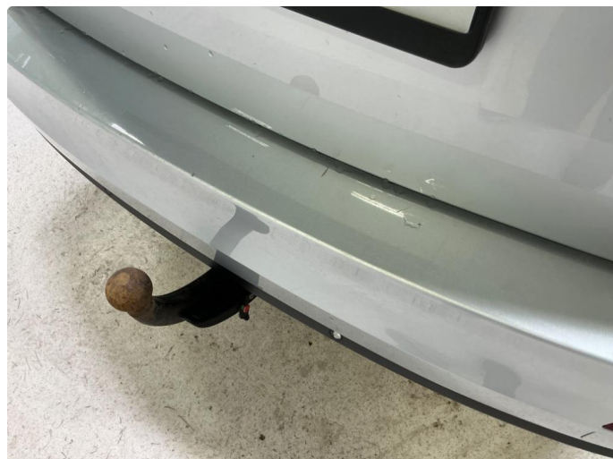
1.11 Riper, sår og mek slitasje innlasting bakfanger
