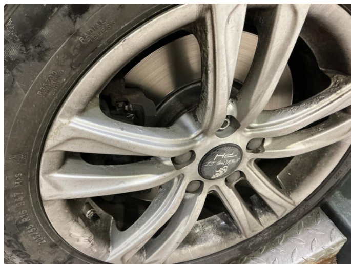
1.9 Vinterfelger oksiderer og korroderer
