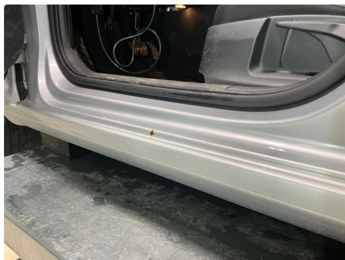
1.10 Venstre innsteg -slitt gjennom lakk
