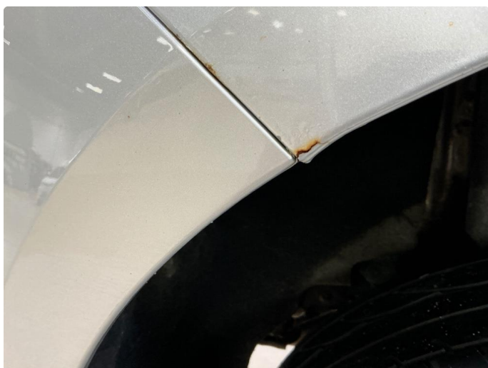
1.7 Høyre og Venstre bakskjerm - rust/korrosjon
