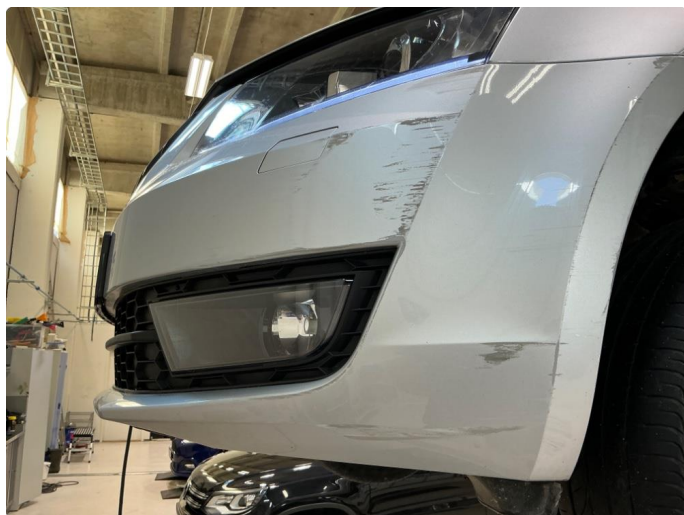
1.12 Støtfanger foran skadet på flere steder .
