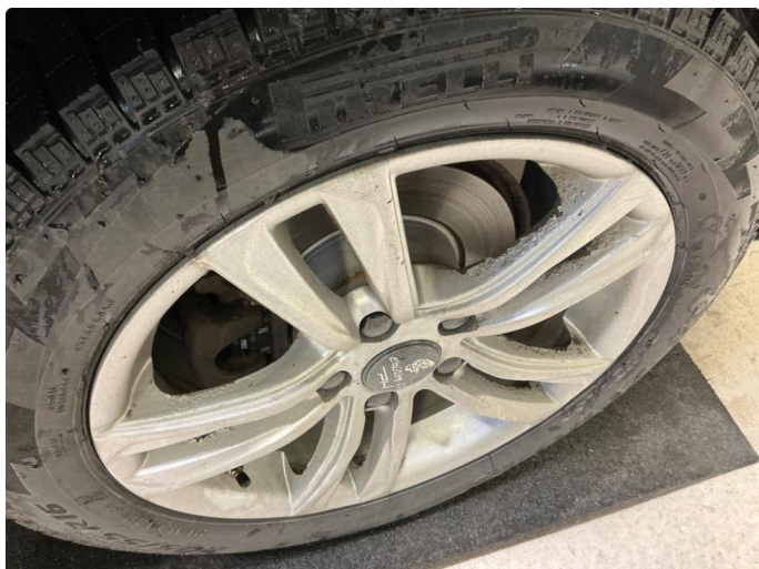
1.9 Vinterfelger oksiderer og korroderer
