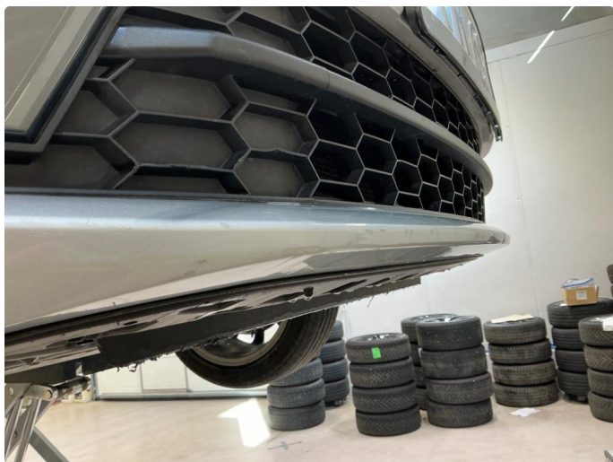
1.12 Støtfanger foran skadet på flere steder .
