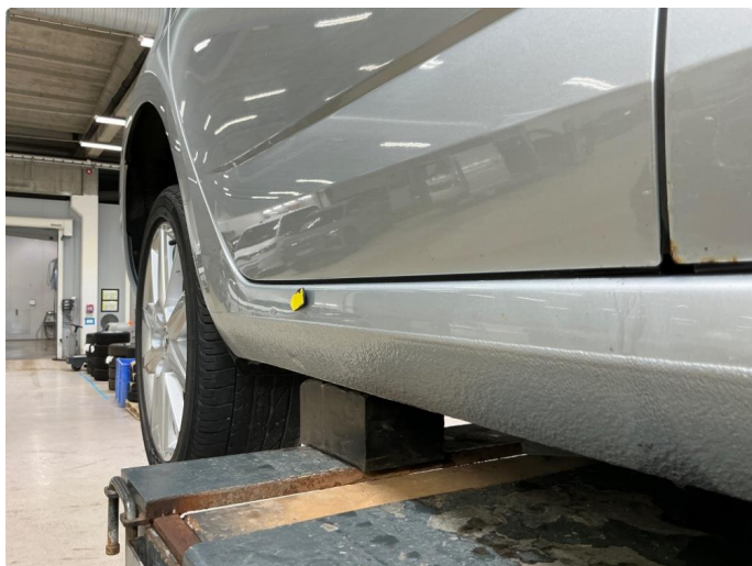
1.14 Småbulker høyre kanal bakkant
