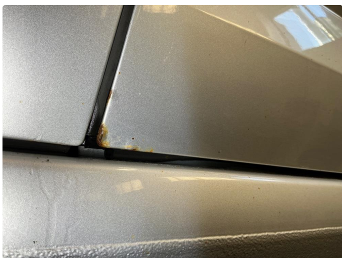
1.3 Høyre dør foran - rust og blærer
