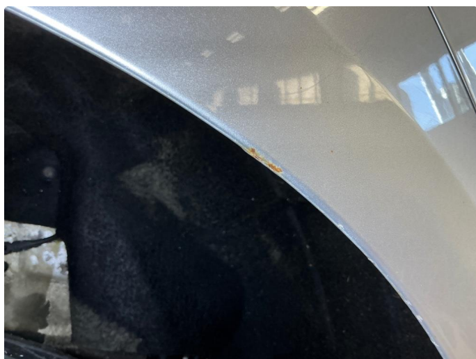
1.7 Høyre og Venstre bakskjerm - rust/korrosjon
