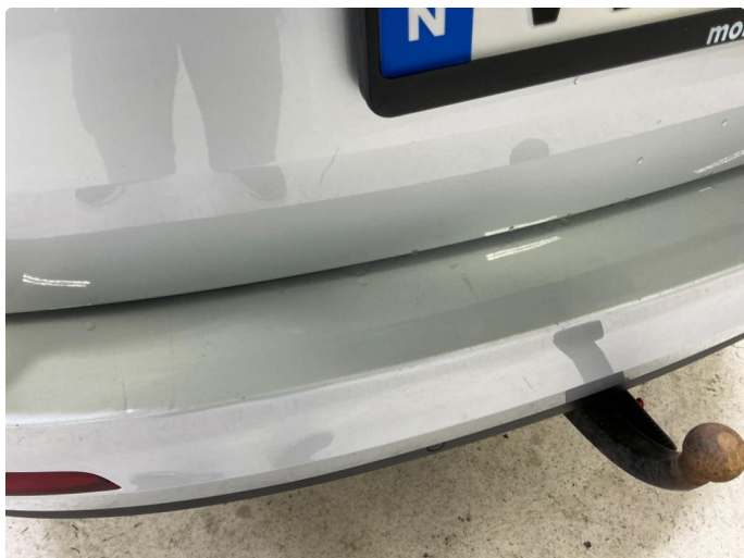
1.11 Riper, sår og mek slitasje innlasting bakfanger
