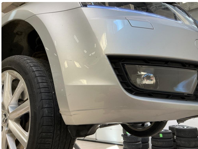
1.12 Støtfanger foran skadet på flere steder .
