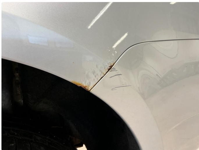
1.7 Høyre og Venstre bakskjerm - rust/korrosjon
