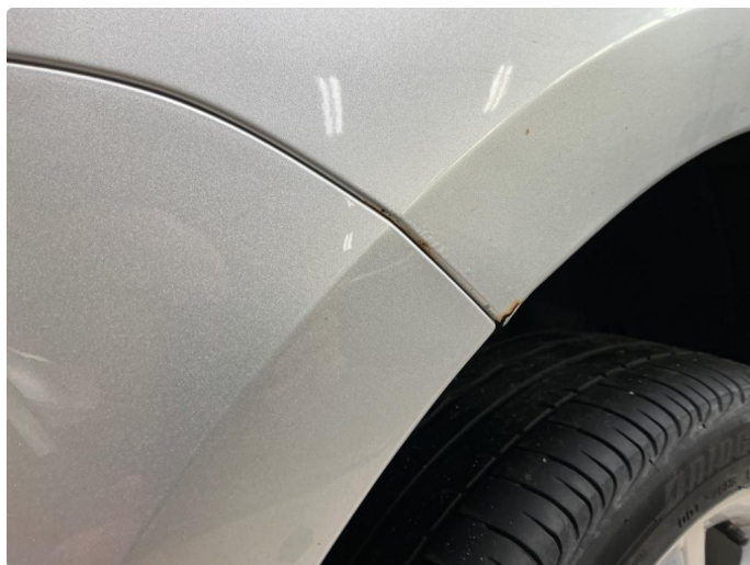
1.7 Høyre og Venstre bakskjerm - rust/korrosjon
