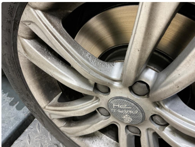
1.9 Vinterfelger oksiderer og korroderer
