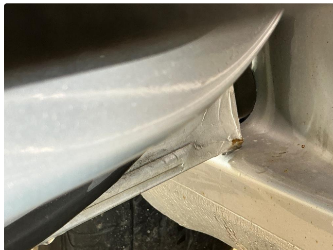
1.4 Venstre dør foran - rust/blærer
