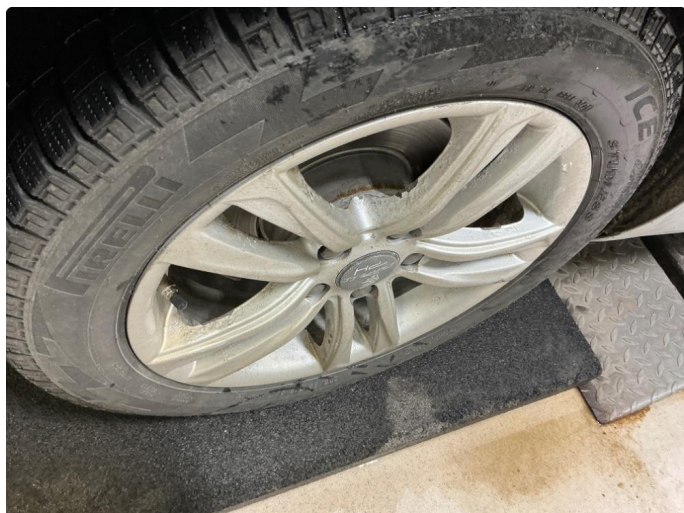
1.9 Vinterfelger oksiderer og korroderer
