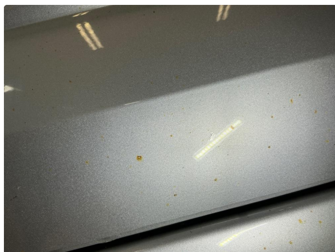
1.4 Venstre dør foran - rust/blærer
