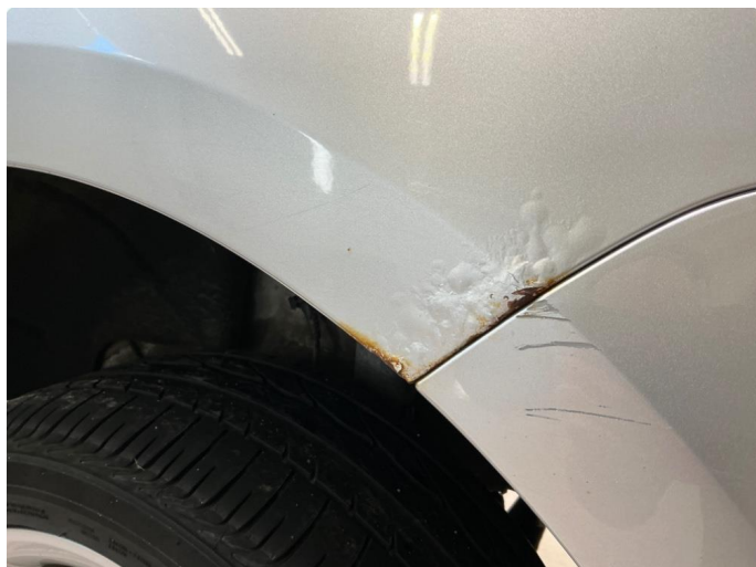
1.7 Høyre og Venstre bakskjerm - rust/korrosjon
