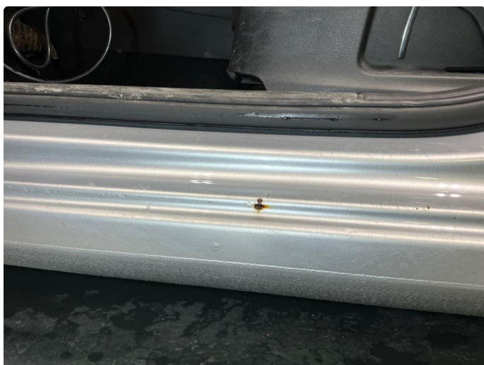
1.10 Venstre innsteg -slitt gjennom lakk
