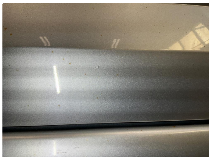
1.3 Høyre dør foran - rust og blærer
