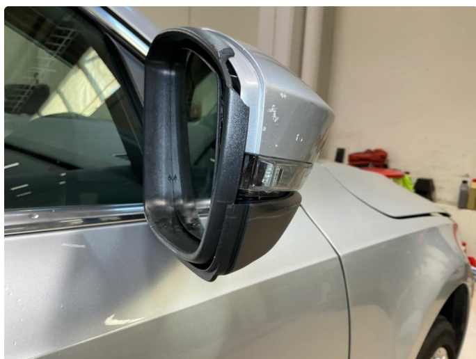
1.8 Høyre speilhus skadet
