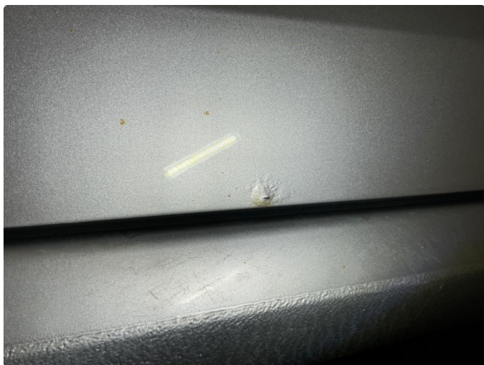
1.4 Venstre dør foran - rust/blærer
