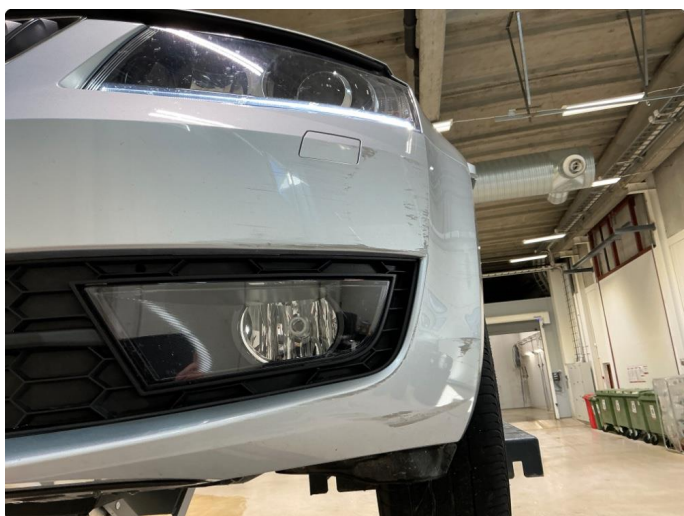
1.12 Støtfanger foran skadet på flere steder .
