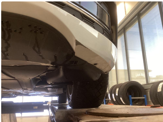
1.3 Noe riper underside støtfanger forran
