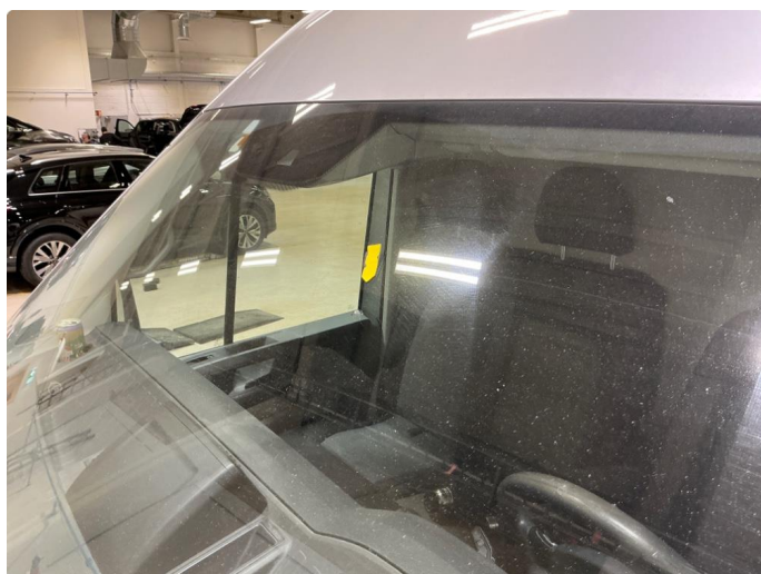
1.14 Tidligere reparert steinsprut i frontruten
