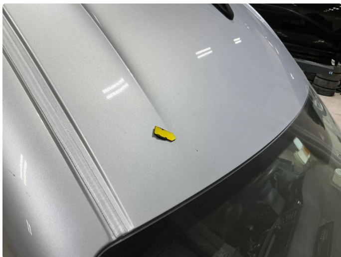
1.12 Steinsprut med rust tak
