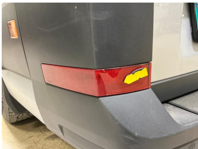
1.10 Sprekk i refleks til støtfangerkappe bak venstre og høyre side
